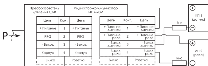
Схема подключения ИК 4-20М к преобразователю давления СДВ или ДД-И общепромышленного исполнения («ИП 2» необходим только для работы функции сигнализатора в исполнениях «01» и «02»).
