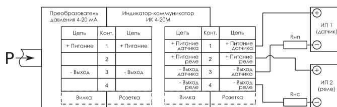
Схема подключения ИК 4-20М к преобразователю с выходным сигналом 4-20 мА («ИП 2» необходим только для работы функции сигнализатора в исполнениях «01» и «02»).
